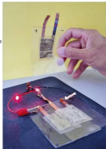
Аккумулятор с углеродными нанотрубками от Технологического института Нью-Джерси
