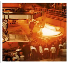
▲ 70-тонная заготовка была отлита при температуре 1600 °C из высококачественного стекла особого состава
