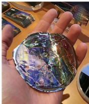
Полупроводниковая пластина IBM сгибается, как фольга
